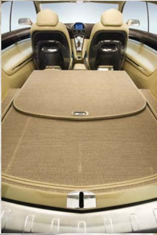
doppelter Boden, dessen obere Hälfte nach dem Einladen wie ein Tablett spielend leicht nach vorn über die geklappten Rücksitze geschoben werden kann. Auch hier wird als Verkleidungsmaterial das unempfindliche Sisal eingesetzt.
